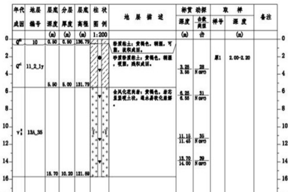
图5.2-1 里程桩号K4+180右侧钻孔地质柱状图
