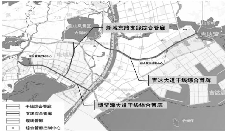
图 1 茂名滨海新区起步区城市地下综合管廊平面总图
