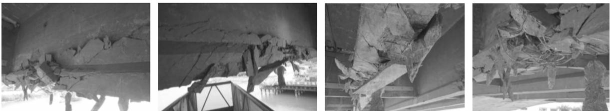
图 6 破损 3#中梁现场照片 1-4
