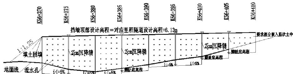
图8 浅埋段重力式挡土墙纵向布置图
