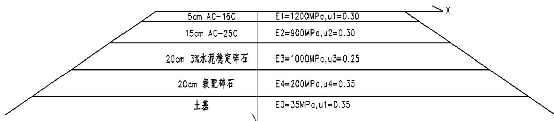
图4 过渡性路面结构图
